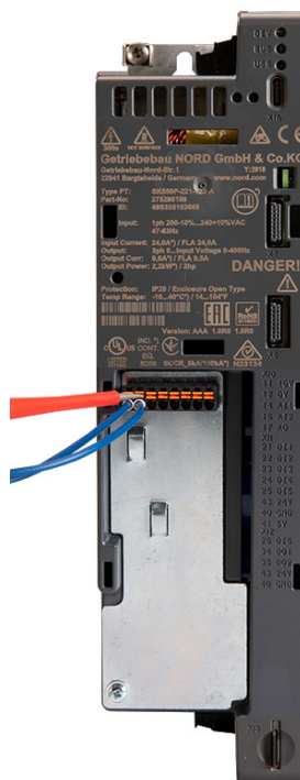
Fijación de las conexiones (tercera mano)
