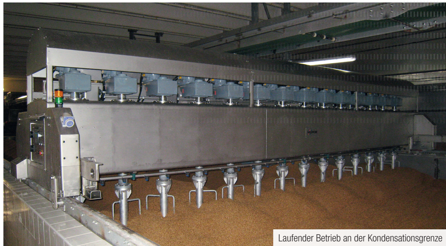
Mälzereiwender mit 14 Antrieben und Fahrtrieb
