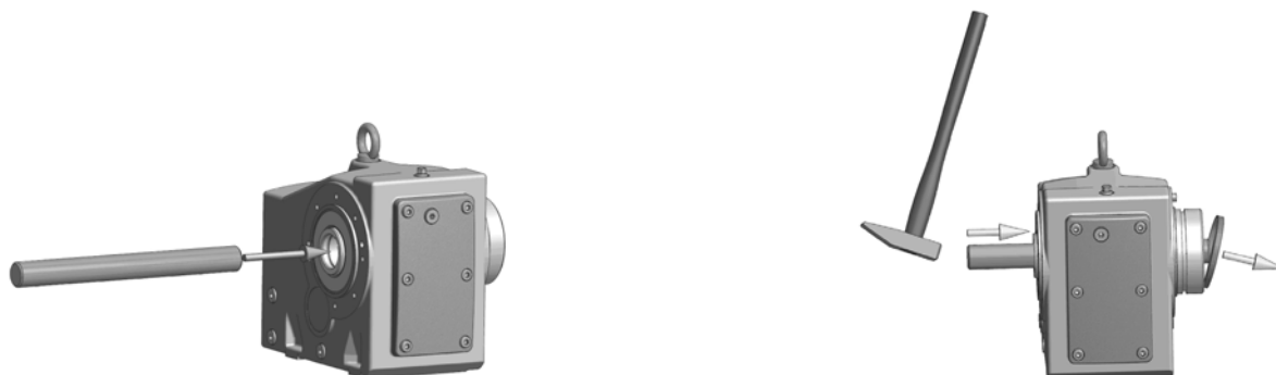
Fig. 5: Demontering av det fabrikkmonterte lokket
