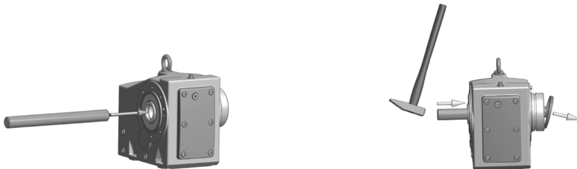
Rysunek 5: Demontaż fabrycznie zamontowanej pokrywy zamykającej
