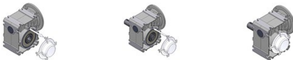
Слика 14: Демонтажа и монтажа за капакот
