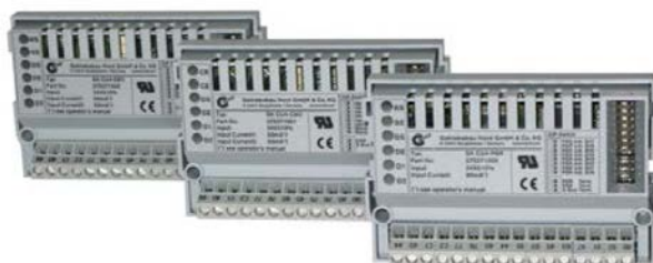
Abbildung 8: interne Kundenschnittstellen SK CU4 ... (Beispiel)
