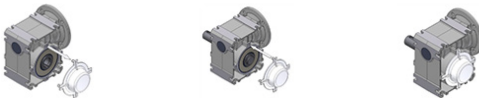
Rysunek 15: Demontaż i montaż pokryw
