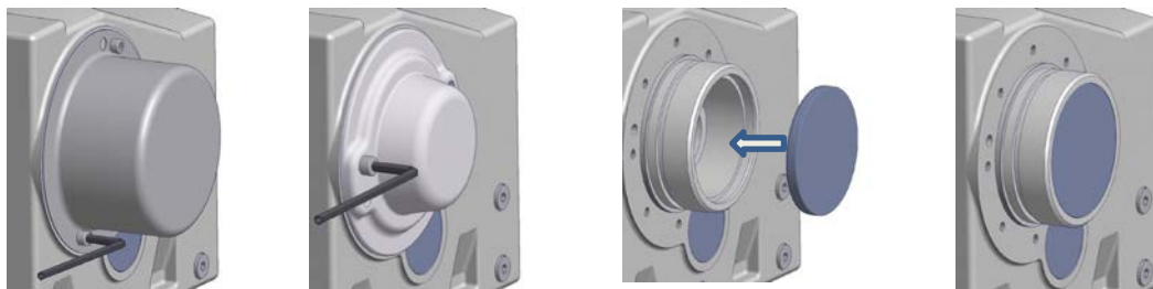
Illustration 14: Montering af beskyttelseshætte Option SH, Option H og Option H66
