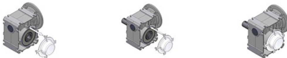
Illustration 15: Afmontering og montering af afdækningshætter
