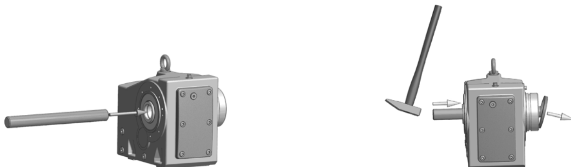
Illustration 5: Afmontering af den fabriksmonterede blindprop
