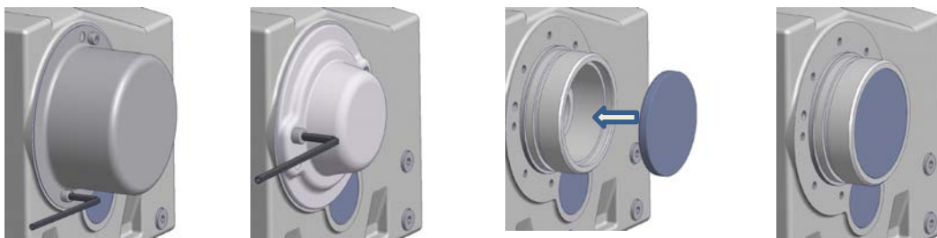
Figura 14: montaggio del coperchio di protezione opzione SH, opzione H e opzione H66
