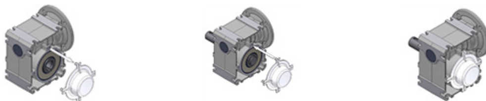
Figura 15: smontaggio e montaggio del coperchio di protezione
