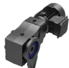
93.1 Gehäuse, B14-Flansch, Drehmomentenarm, Hohlwelle, integrierter Motor
