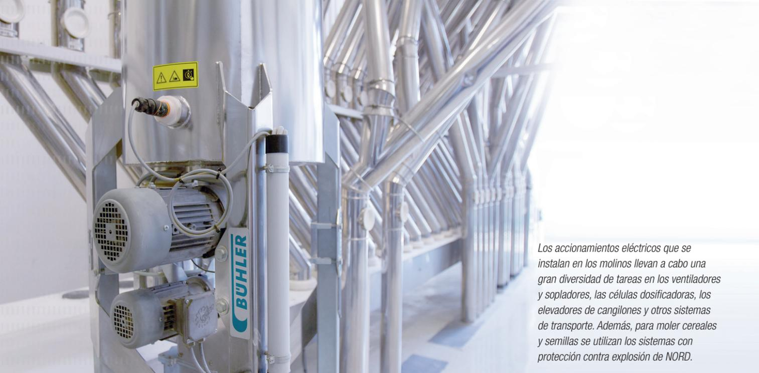
Los accionamientos eléctricos que se instalan en los molinos llevan a cabo una gran diversidad de tareas en los ventiladores y sopladores, las células dosificadoras, los elevadores de cangilones y otros sistemas de transporte. Además, para moler cereales y semillas se utilizan los sistemas con protección contra explosión de NORD.
