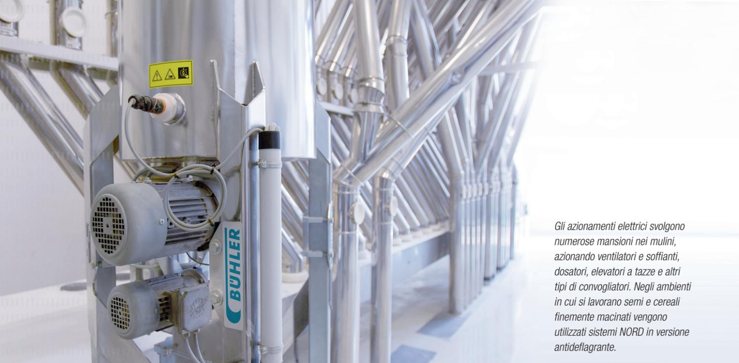
*Gli azionamenti elettrici svolgono numerose mansioni nei mulini, azionando ventilatori e soffianti, dosatori, elevatori a tazze e altri tipi di convogliatori. Negli ambienti in cui si lavorano semi e cereali finemente macinati vengono utilizzati sistemi NORD in versione antideflagrante.*
