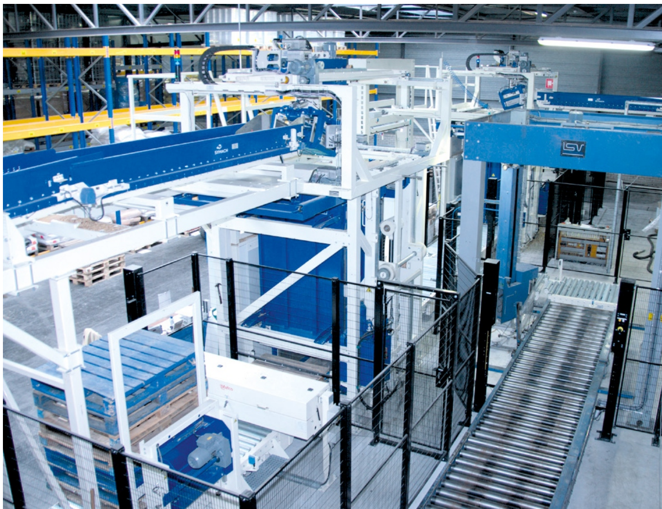
Paletyzery z decentralnie sterowanymi asynchronicznymi układami napędowymi
